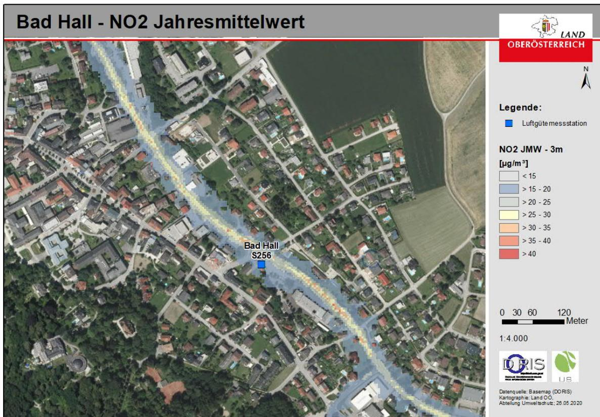
Abbildung 26: Simulierte NO<sub>2</sub>-Immissionen in 3 m über Grund (Gesamtbelastung mit Straßenverkehr + Hausbrand + Hintergrund)
