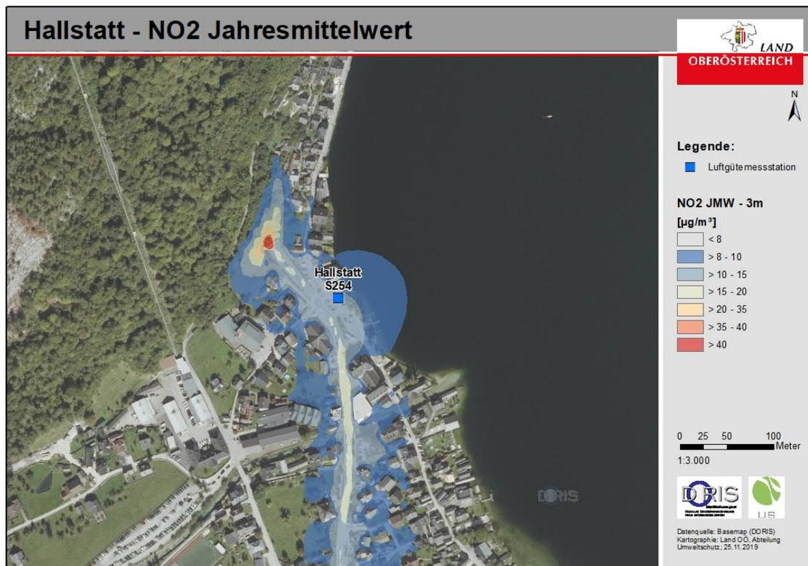
Abbildung 31: Simulierte NO<sub>2</sub>-Immissionen in 3 m über Grund (Gesamtbelastung mit Straßenverkehr + Hausbrand + Hintergrund)
