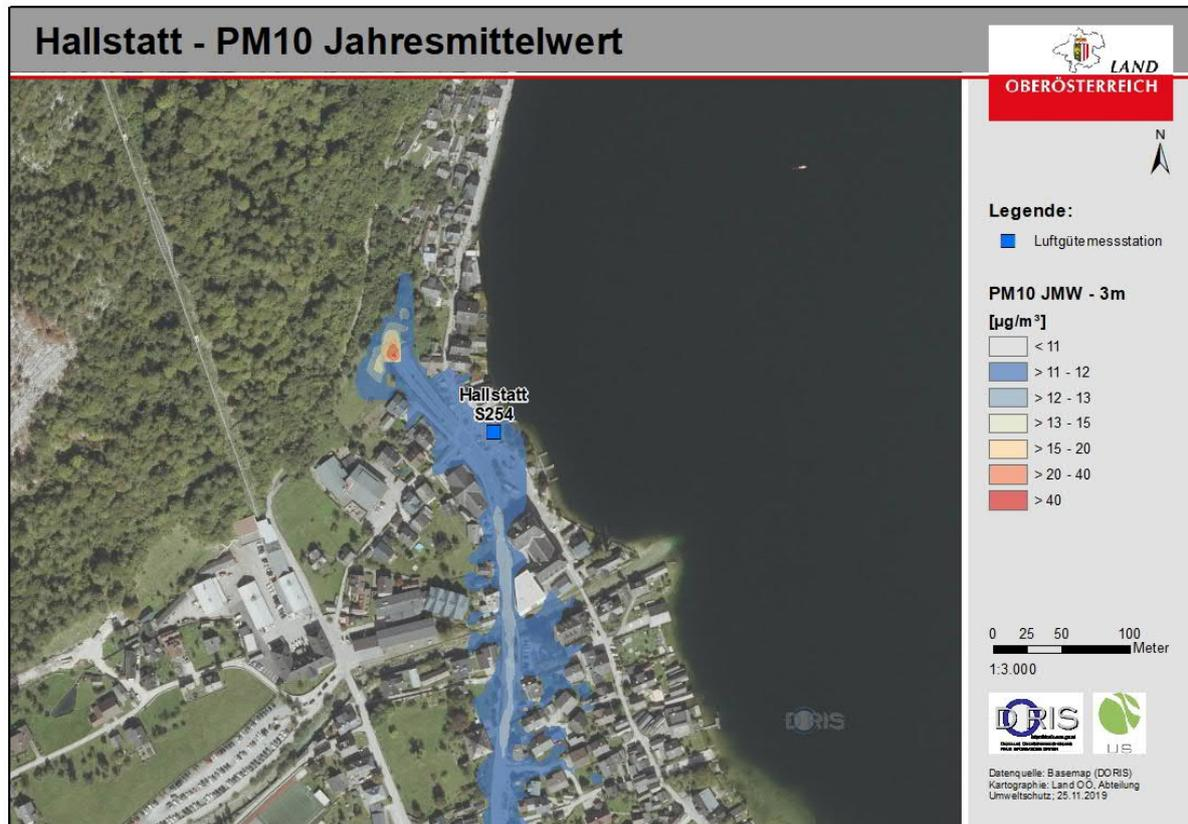
Abbildung 32: Simulierte PM<sub>10</sub>-Immissionen in 3 m über Grund (Gesamtbelastung mit Straßenverkehr + Hausbrand + Hintergrund)
