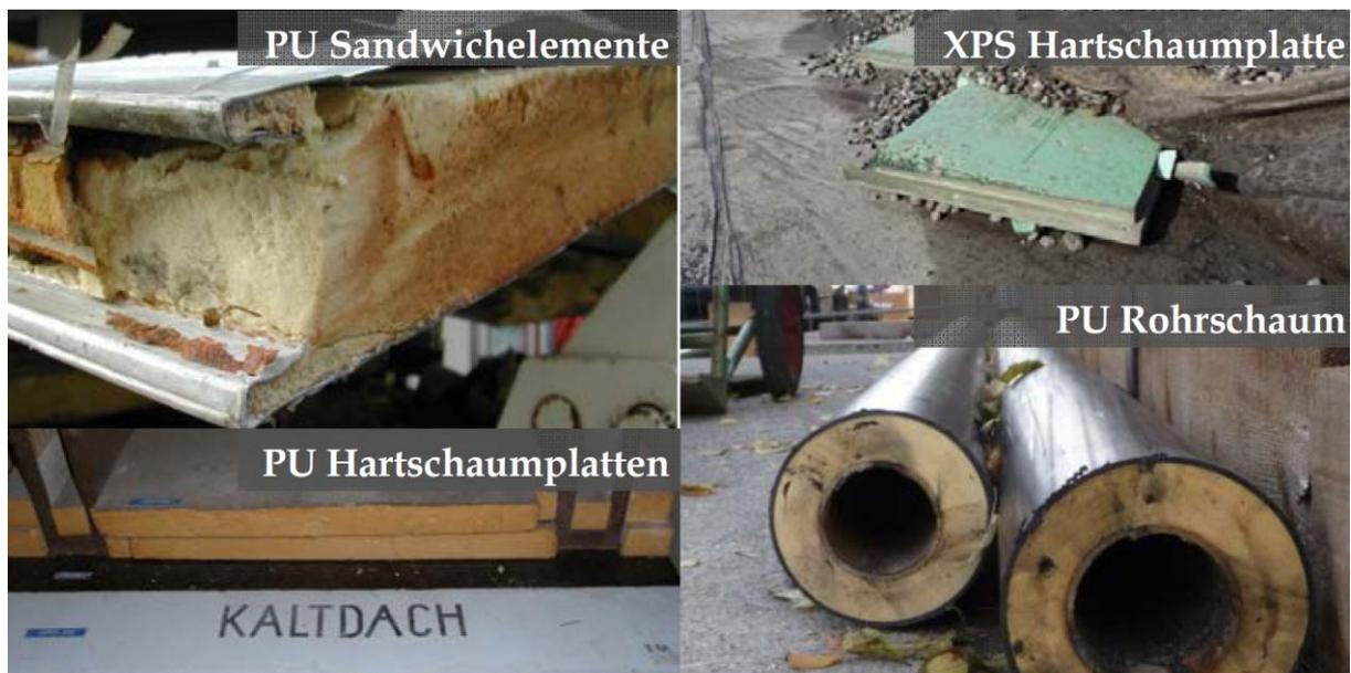
Abbildung 3-6: Fotodokumentation von FCKW (Ausgewählte Bildbeispiele aus dem Schadstoffkatalog)
