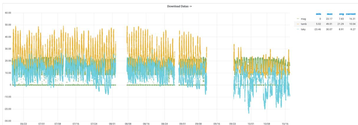
Abbildung 5 – Daten der TESS-Messstation im Nationalpark Gesäuse (Weidendom) von Mitte Juni bis Mitte Oktober 2024. Grün = Magnitude der Himmeshelligkeit, gelb = Umgebungstemperatur, blau = Himmelstemperatur (zur Berechnung der Wolkenbedeckung)
