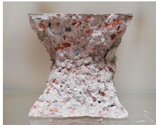
Bruchbild nach der Druckfestigkeitsprüfung
