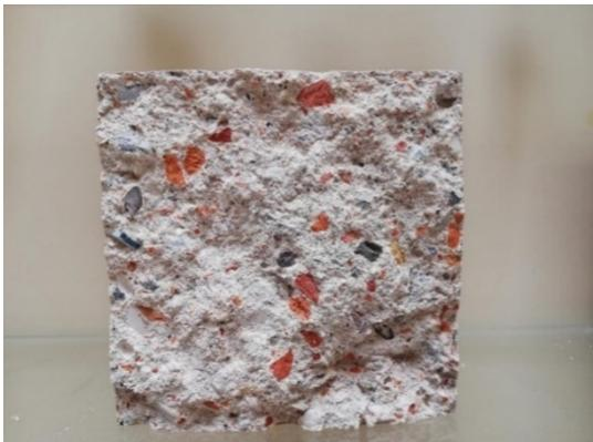
Bruchbild nach der Spaltzugfestigkeitsprüfung
