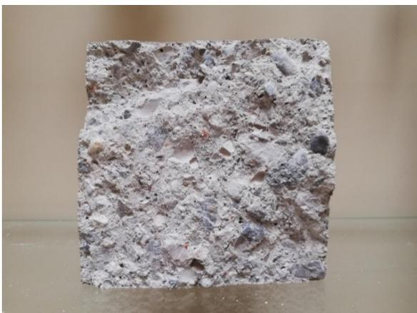
Bruchbild nach der Spaltzugfestigkeitsprüfung
