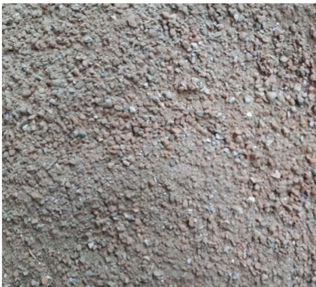
Abbildung 22: 0/4 Beton-Ziegel-Splitt ungewaschen
