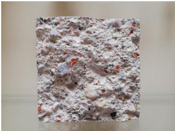
Bruchbild nach der Spaltzugfestigkeitsprüfung
