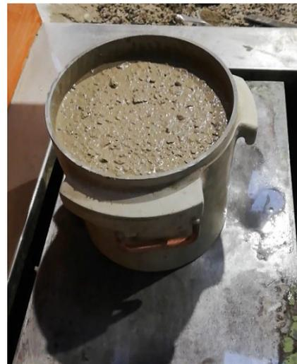
Luftporentopf nach dem Verdichten
