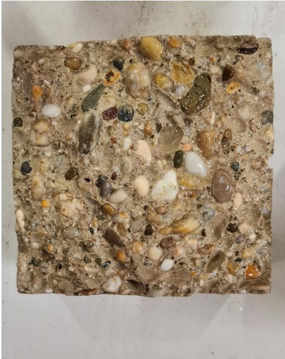
Bruchbild nach der Spaltzugfestigkeitsprüfung
