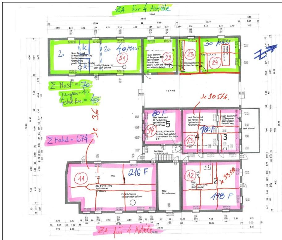
Abbildung 2: Skizze der geplanten Zentrallüftungsanlagen für die Schweinestallungen im Hofgebäude
