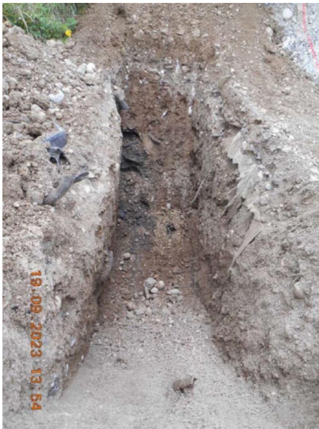
Abb. 2 Schurf 1 vom Böschungsfuß unter das Wegplanum reichend, ungefähr auf Höhe von Schnitt AR7; max. Schurftiefe ca. 2 m.
