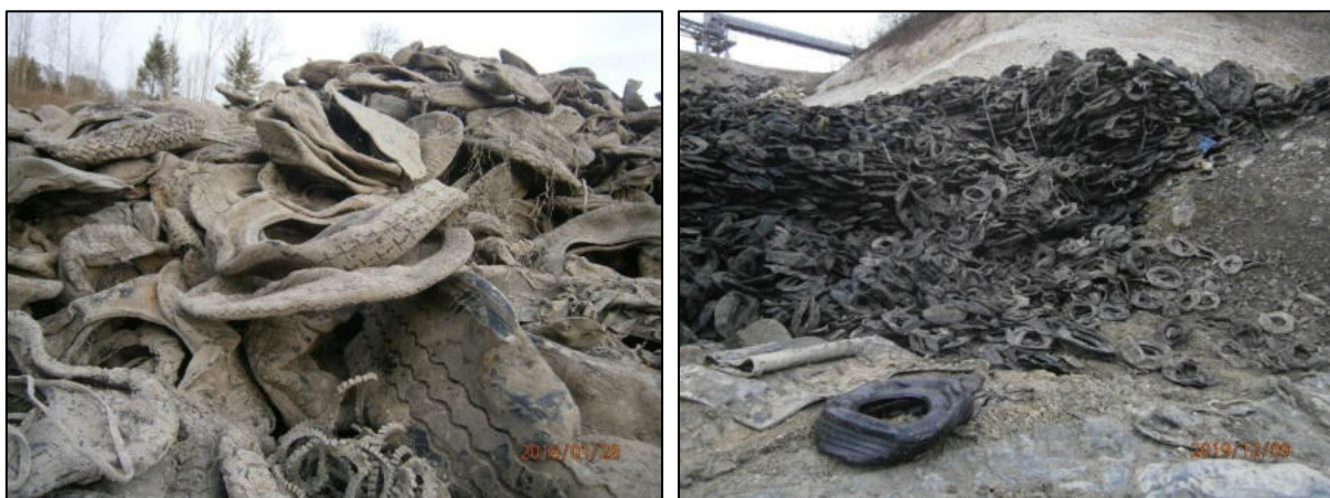
Abb. 2: stark komprimierte Altreifen (links im Jänner 2016 etwa 12 m unter der ehemaligen Geländeoberkante, rechts im Dezember 2019 etwa 18 m unter GOK)
