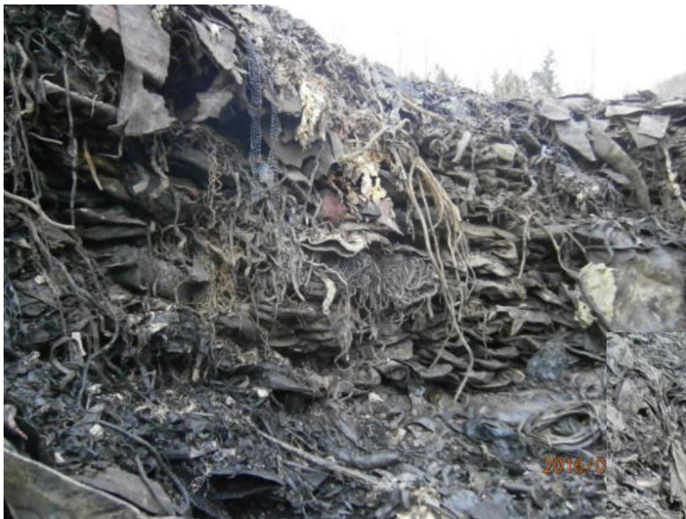
Abb. 4 Ca. 3 m tiefe Erkundungsschürfe im Sanierungsbereich „Lager Bienenhütte“. Fotos: J. Ebner, ERG GmbH, 28.01.2016
