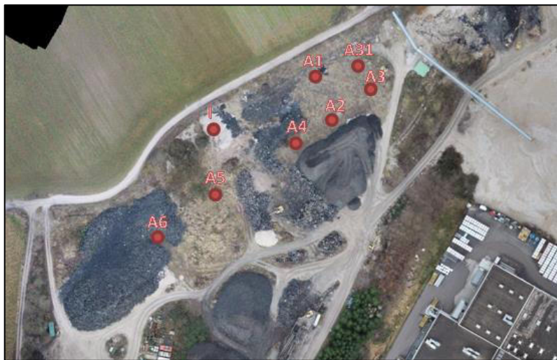
Abb. 5: Position der Gas- und Temperatursonden am Alten Reifenlager seit März 2019
