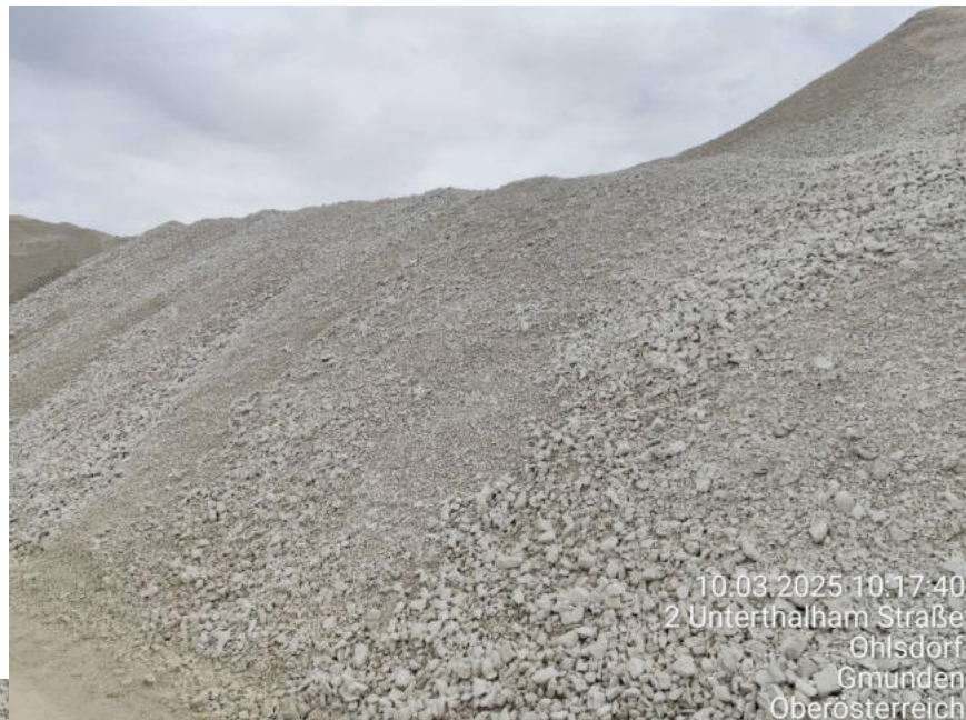
Abb. 3 Aufbereitungslager der Fa. Asamer Kies- u. Betonwerke GmbH, Standort Ohlsdorf, mit Recycling-Frostkoffer aus aufbereitetem Tunnelausbruchmaterial.
