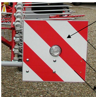
Reflektierende Warnmarkierung mit Zusatzbeleuchtung nach vorne
