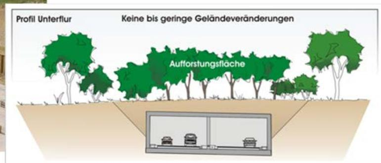
Abbildung 5: Schemadarstellung einer Unterflurtrasse
