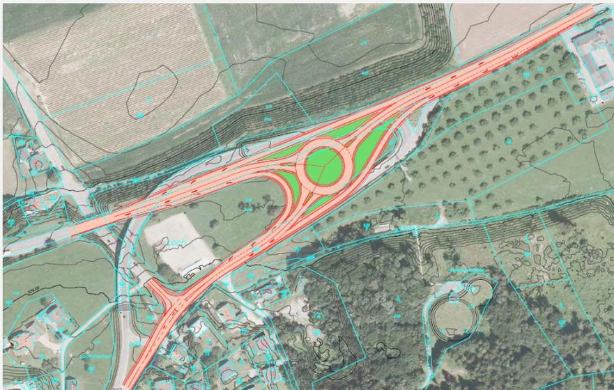
(Abb.: Schema-Skizze Kreisverkehrsanlage aus der Variantenuntersuchung)
