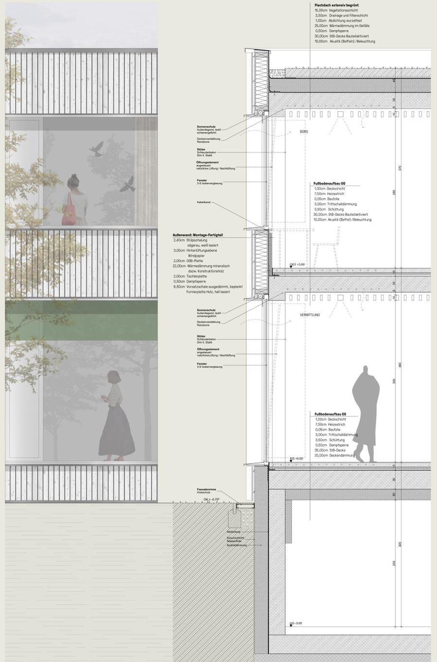
FASSADEN-TEILANSICHT/ DETAILSCHNITT M 1:20
