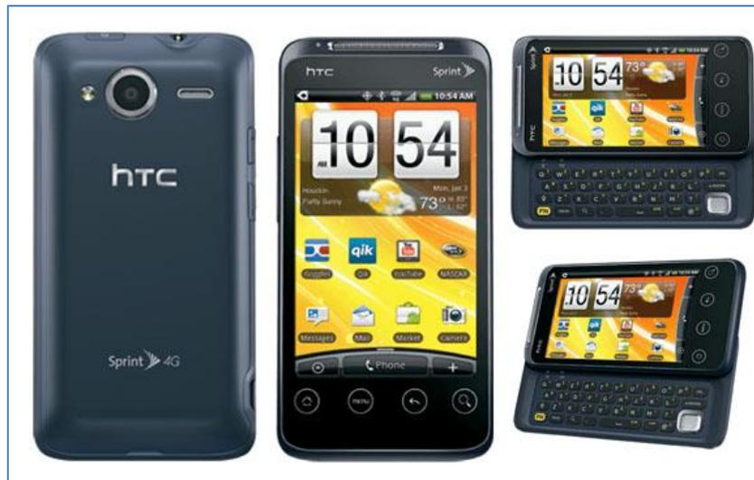
Abbildung 70: Mobiltelefon mit WiMAX (IEEE802.16) und WLAN (IEEE802.11) - HTC EVO 4G
