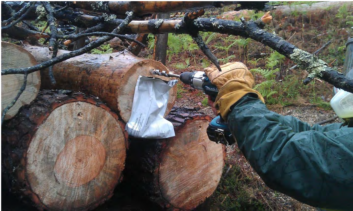
Abb. 10: Probenahme mittels Akku-Bohrmaschine und Schlangenbohrer
