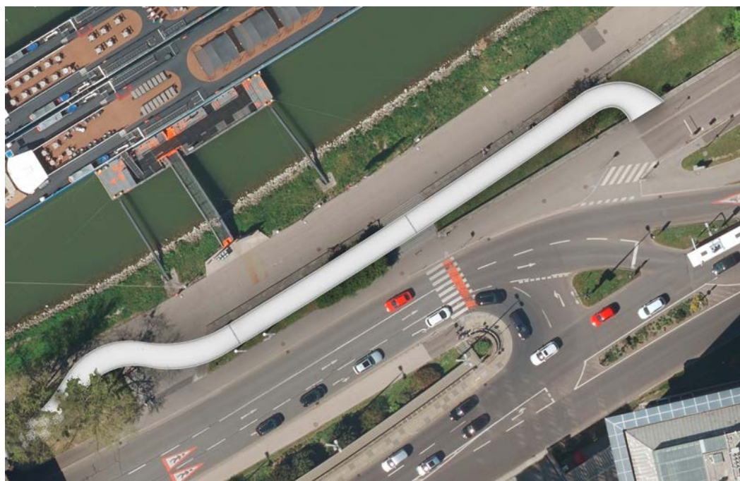
Die Lentos-Rampe hat eine Nutzbreite von 3,50 bis 3,90 Metern bei einer Länge von rund 120 Metern.
