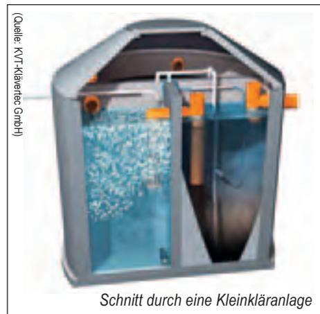
Schnitt durch eine Kleinkläranlage
