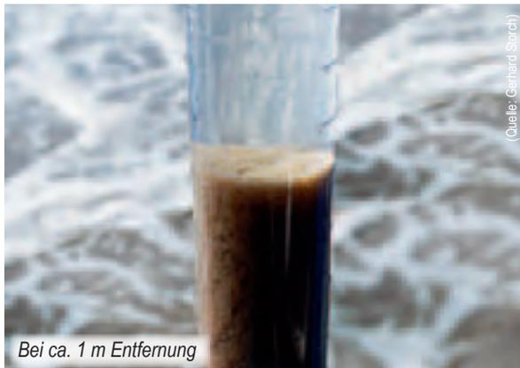
Aus unmittelbarer Nähe sieht man deutlich, dass der Schlamm aus lauter kleinen Flocken besteht. Aber schmutzfressende Lebewesen kann man noch lange nicht erkennen. Dieser Schlamm setzt sich leicht ab, sodass Schlamm und gereinigtes Abwasser voneinander getrennt werden können. Dies geschieht in den Nachklärbecken. Der Schlamm setzt sich dort am Boden ab und das gereinigte Abwasser kann in ein Gewässer eingeleitet werden.
