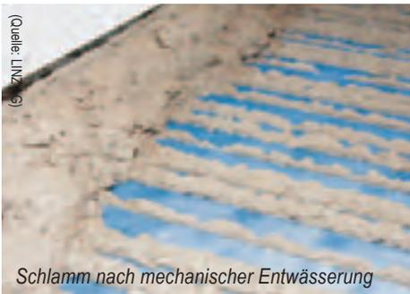
Schlamm nach mechanischer Entwässerung
