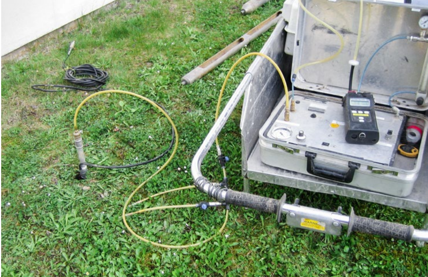
Gerät zur Messung der Bodenluft, Quelle: Land OÖ, AUWR
