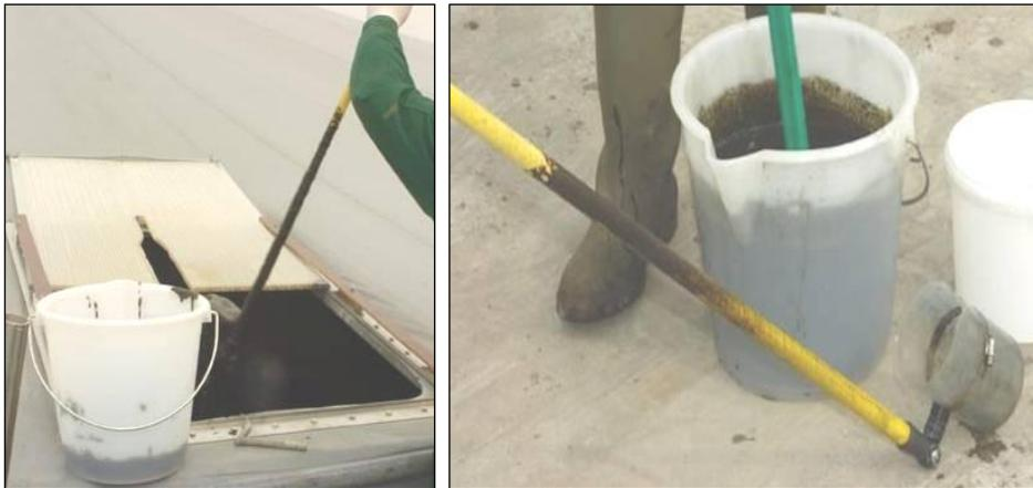
Abbildung 8: Gärrestprobenahme aus einem Pumpschacht der Biogasanlage B.
