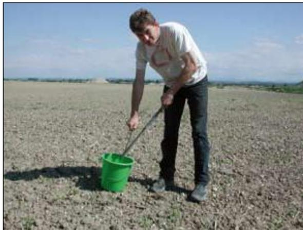
Abbildung 6: Bodenprobenahme mit Bodenbohrer. © Bundesgütegemeinschaft Kompost e.V., 2009.
