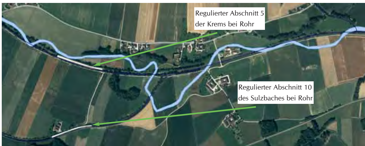
Abb. 102: Projektion des Krenslaufes um 1800 auf einen Teil der aktuellen Regulierungsstrecke „Kematen“ bei Rohr im Kremstal
