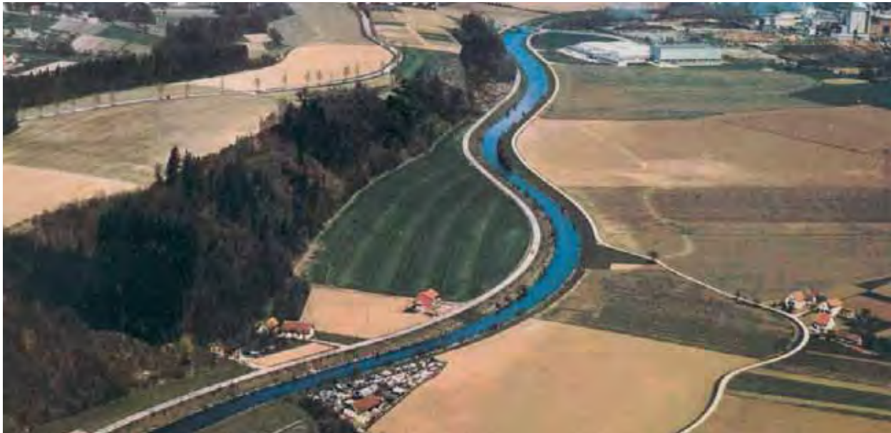
Abb. 2: Regulierung der Krens bei Weißenberg-Nettingsdorf (Quelle: PAPLHAM et al. 1976)
