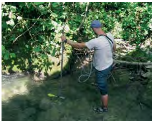
Abb. 14: Die Fließgeschwindigkeitsmessung erfolgte mit einem magnetisch-induktiven Strömungssensor (Ott Nautilus C 2000 / Sensa Z 300).
