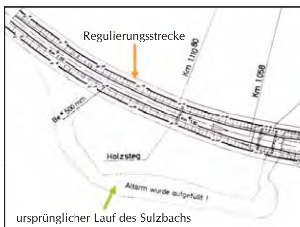
Abb. 109: Ausschnitt aus dem Regulierungsoperat des Sulzbaches (Bauabschnitt 1)
