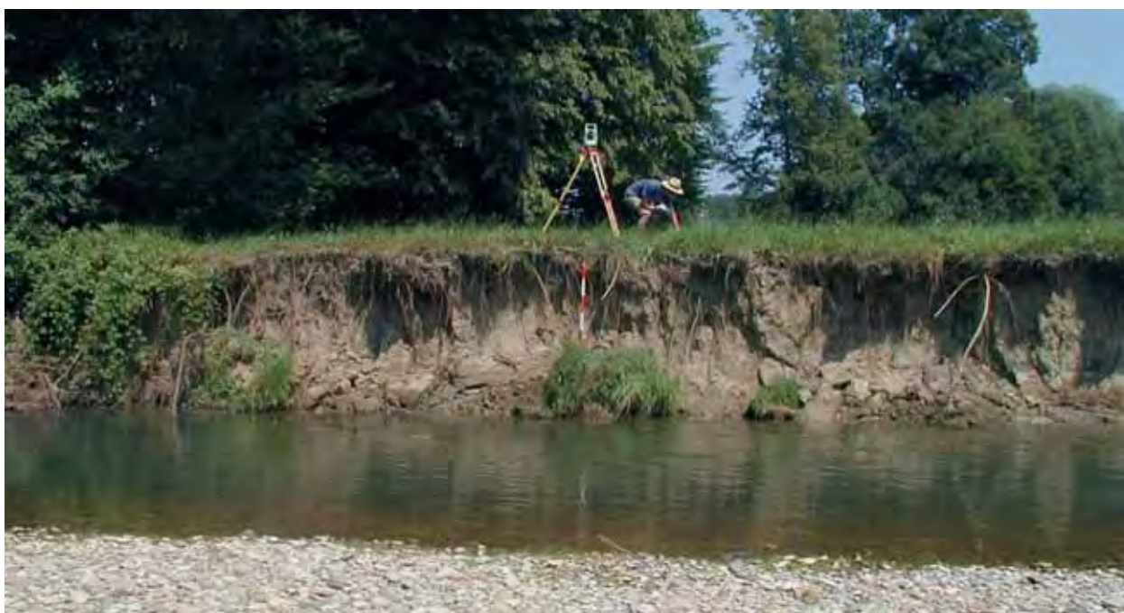
Abb. 12: Geodätische Vermessung eines Kreamsprofils
