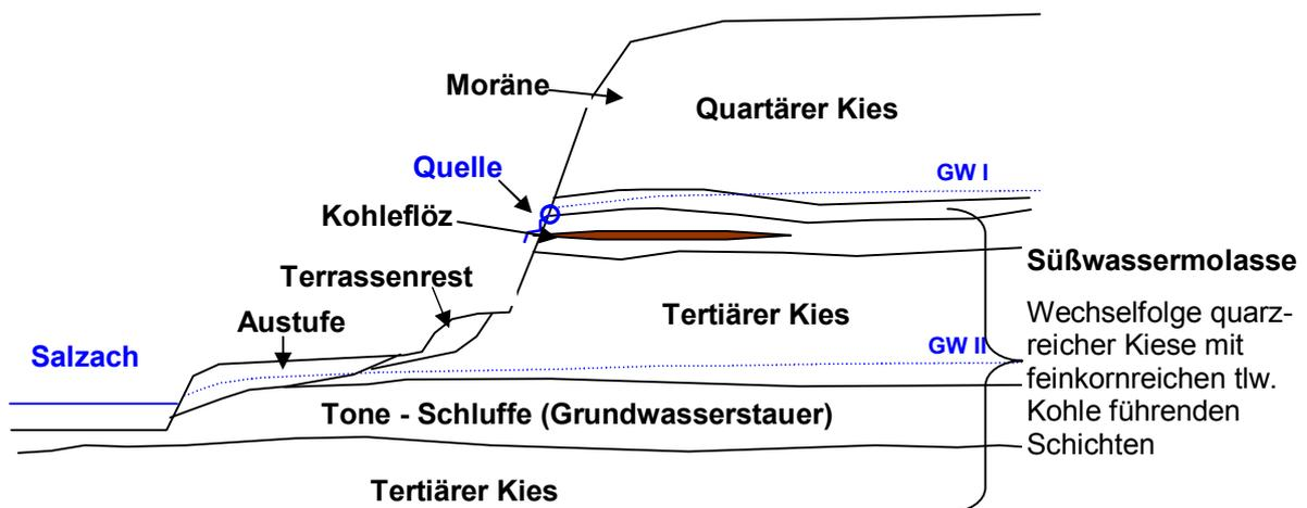
Abbildung 4: Schematischer geologisch-hydrogeologischer Schnitt zwischen Salzach und Salzachleiten
