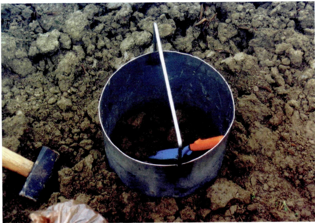
Abbildung 7: Probennahme mittels Stechzylinder
