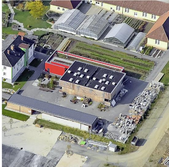
Das Gebäude ist ein funktionaler Holzbau, der nach Bedarf um eine Achse bzw. einen Unterrichtsraum erweitert werden kann.
