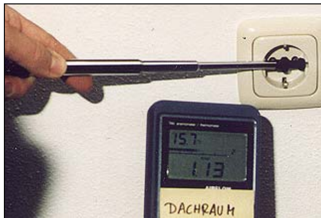
Abb. 5: Zugluftmessung bei einer Steckdose
