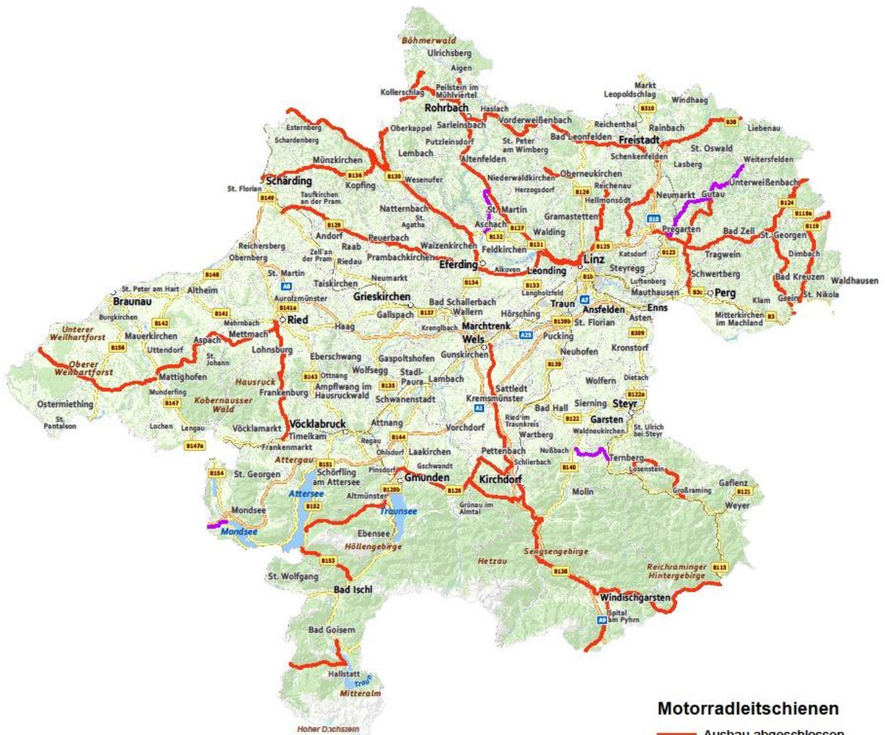
Abbildung 12: Neuralgische Motorradstrecken mit Motorrad-Leitschienen-Unterfahrtschutz (Quelle Land OÖ)
