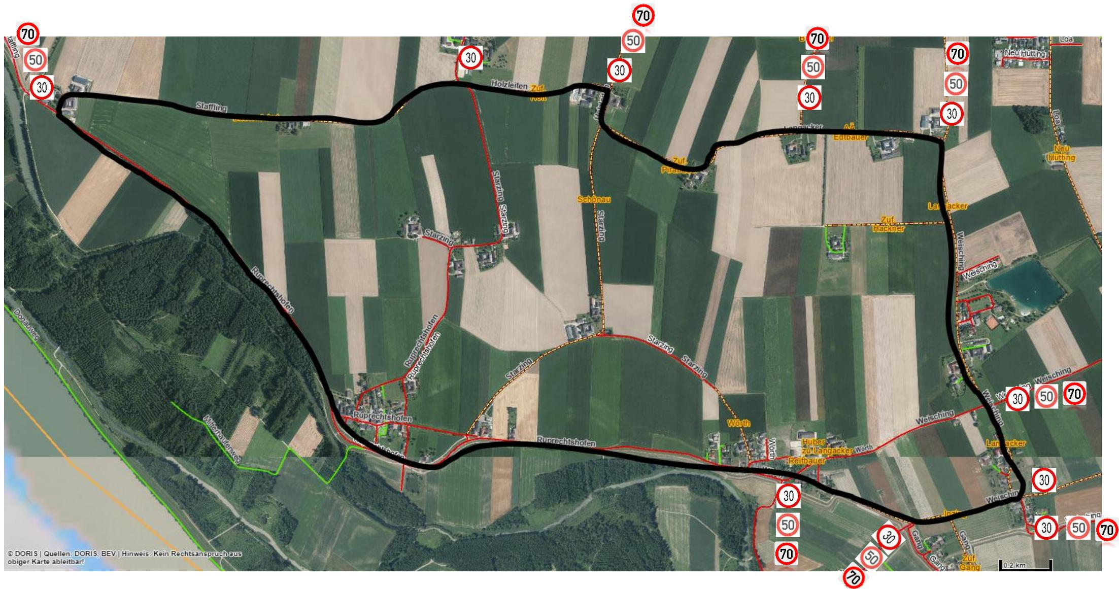
Die 70 km/h Geschwindigkeitsbeschränkung ist jeweils 100m, die 50km/h Geschwindigkeitsbeschränkung 50m sowie die 30km/h Geschwindigkeitsbeschränkung 25m vor dem gesperrten Bereich aufzustellen.
