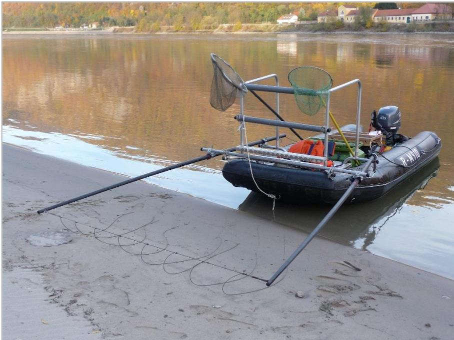
Abb. 13 *Verwendetes Fangboot: Am Bug ist der Anodenrechen an zwei Auslegern befestigt und bootsmittig werden Stahlseilspinnen als Katoden mitgeführt.*
