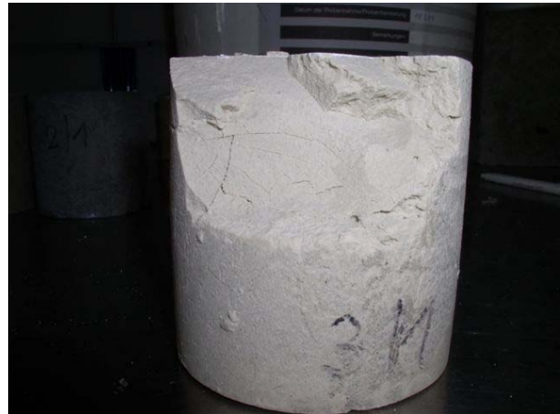
Abbildung 34, Probekörper mit Riss in Stirnfläche und gebrochener Probekörper
