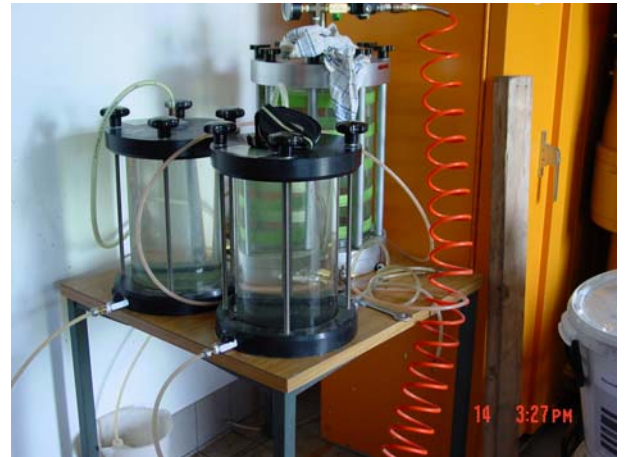
Abbildung 10, Druckzylinder mit Druckregelung
