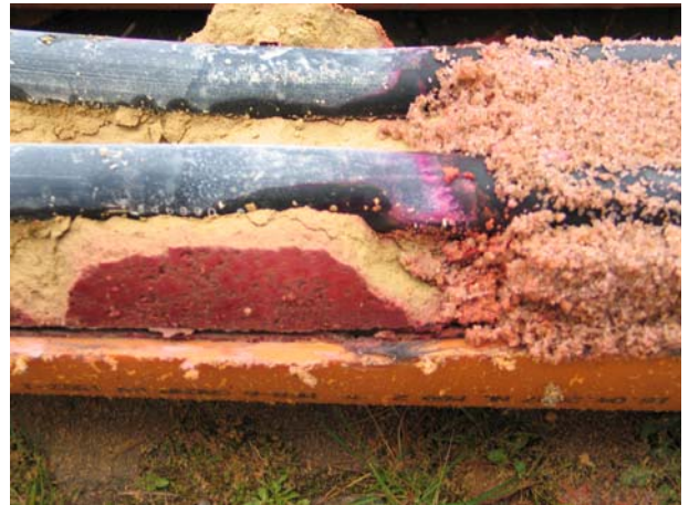
Abbildung 30, Detail Anlagerung Tracer
