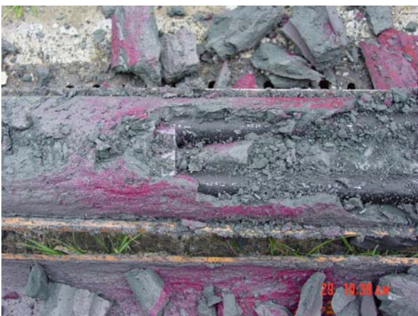
Abbildung 25, Detail Traceranlagerung an Mantelfläche
