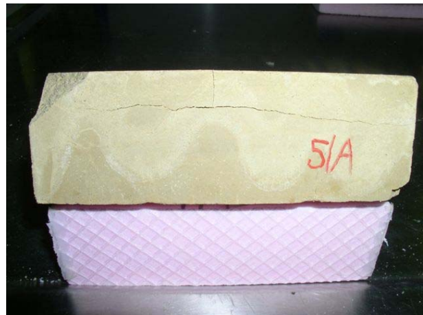
Abbildung 35, Quaderförmige Probekörper mit horizontalen Rissen und Abplatzungen
