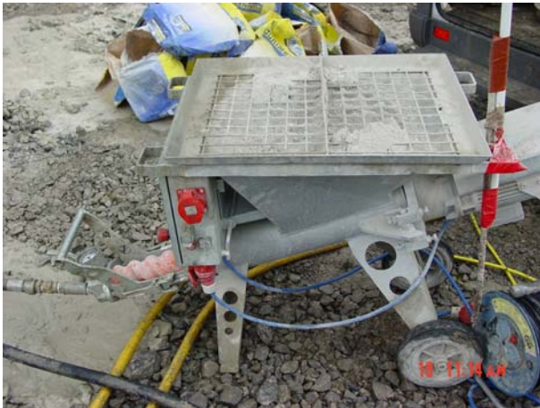
Abbildung 7, Schneckenpumpe zum Anmischen
