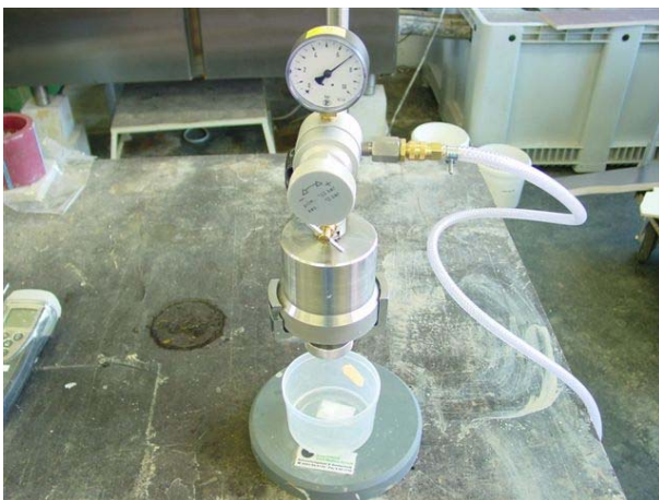
Abbildung 3: Filterpresse zur Bestimmung der Filtratwasserabgabe
