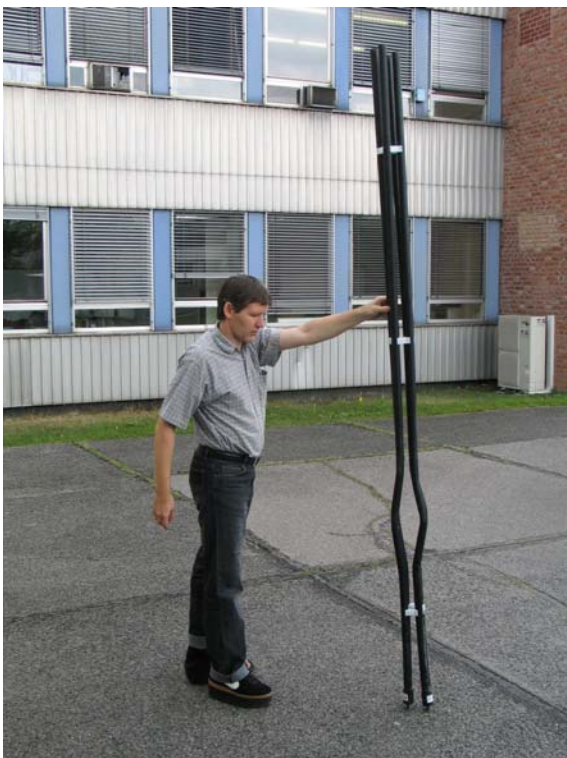
Abbildung 11, Knick in Sondenverrohrung
