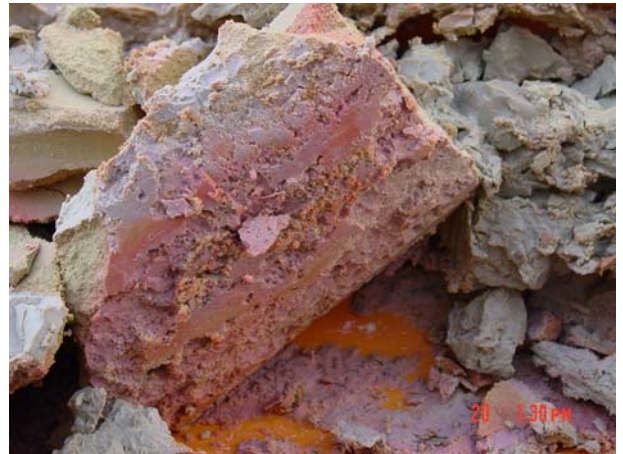
Abbildung 36, VK5, Detail Bentonitpfropfen
