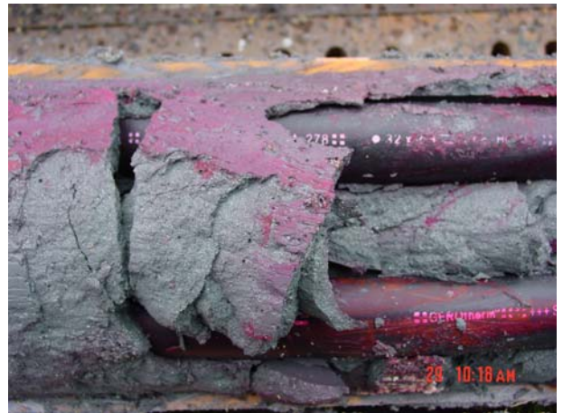
Abbildung 18, VK2, Detail Tracerablagerung
