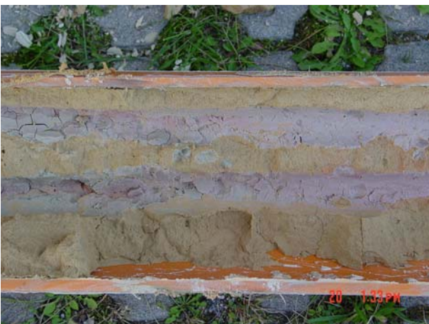
Abbildung 37 und 38, VK5 Bentoniteinspülung entlang der Sondenverrohrung
