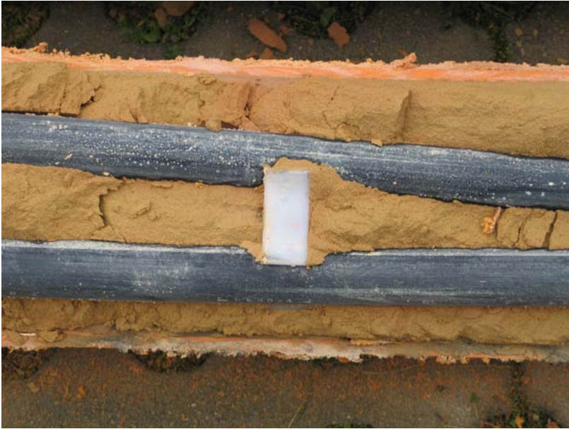
Abbildung 42, Vollständige Umhüllung des Abstandhalters bei Verpresskörper 5
