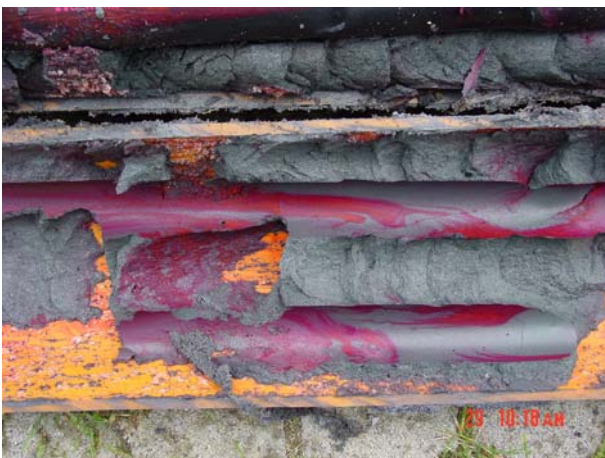
Abbildung 19, VK2, Detail Tracerablagerung an Grenzfläche zu Sondenverrohrung
