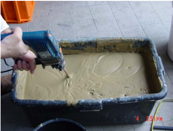
Abbildung 9, Anrühren der Suspension
