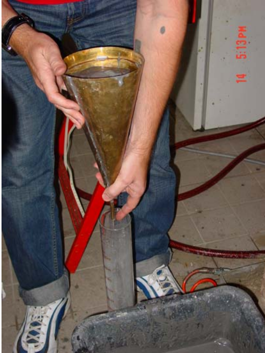
Abbildung 2: Bestimmung der TAZ mittels Marshtrichter
