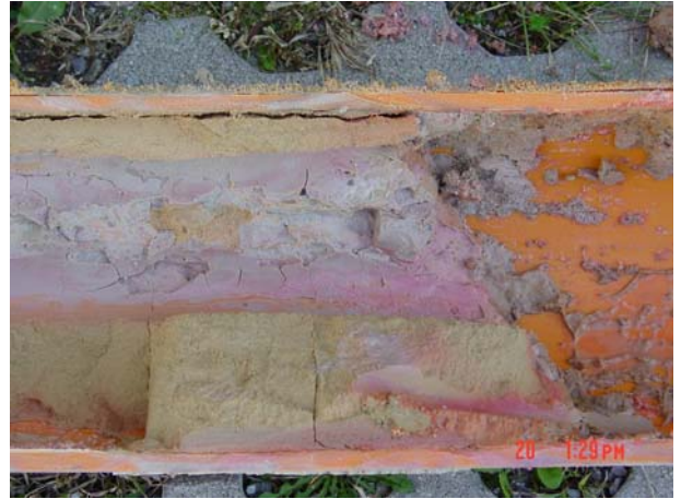
Abbildung 37 und 38, VK5 Bentoniteinspülung entlang der Sondenverrohrung
